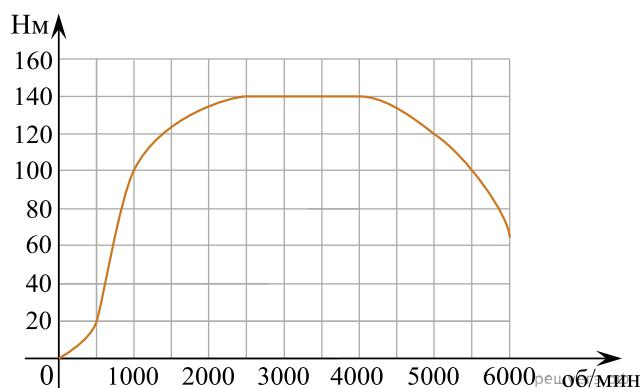
Определите по графику, какого наименьшего числа оборотов двигателя в минуту достаточно, чтобы автомобиль начал движение.
