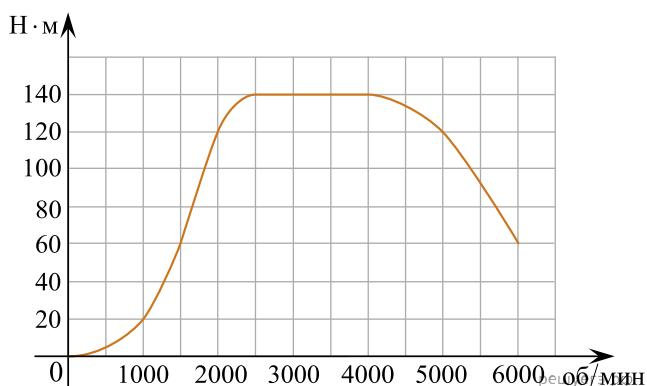
Пользуясь графиком, поставьте в соответствие каждому интервалу количества оборотов двигателя характеристику зависимости крутящего момента двигателя на этом интервале.
